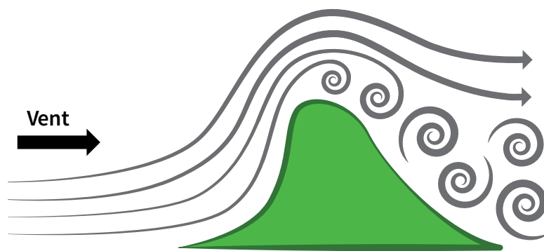
Figure 54 : Turbulence, en aval d'obstacles
